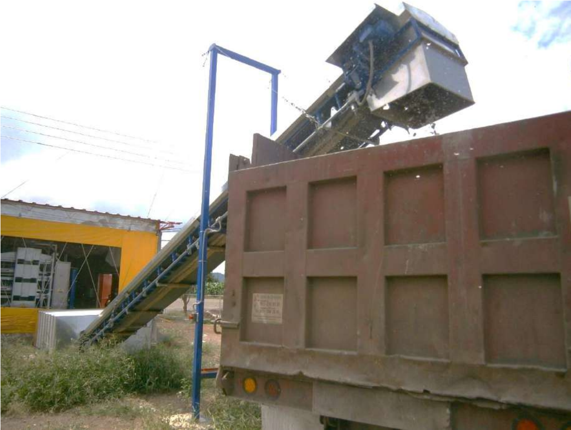
Fotografía: sistema de recolección de gallinaza exterior de caseta.
