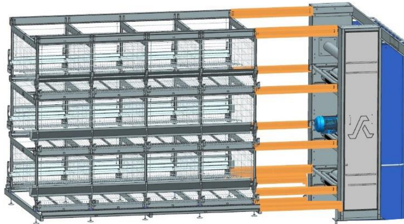
1.- Detalle de Unión del Riel Superior al Banco trasero.
