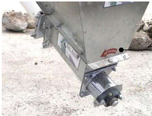
Bota de tolva con señalización de giro del "sin fin".
