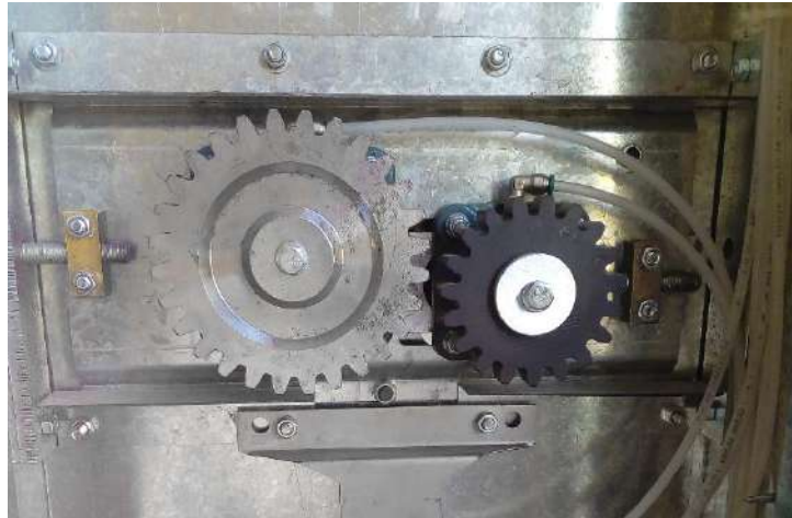
Engranaje metálico con Nylamid, no es necesario lubricar.
